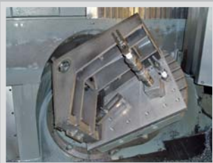
5-Achsen Bearbeitung. Das Bauteil wird in der zweiten Spannung, an allen Funk- tionsseiten komplett bear- beitet.
