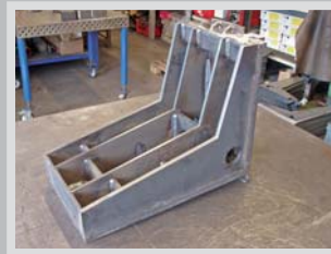
Komplett geschweiß- und geschliffenes Bauteil.
