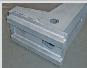
Das Bauteil wurde span- nungsarm gegläht und sandgestrahlt.
