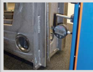
Vermessen nach Protokoll. Hierbei werden alle Maße überprüft und eingetragen.
